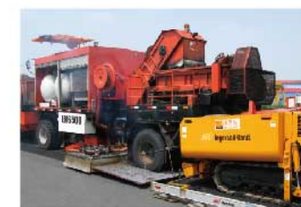
摊铺前对下承层再加热
