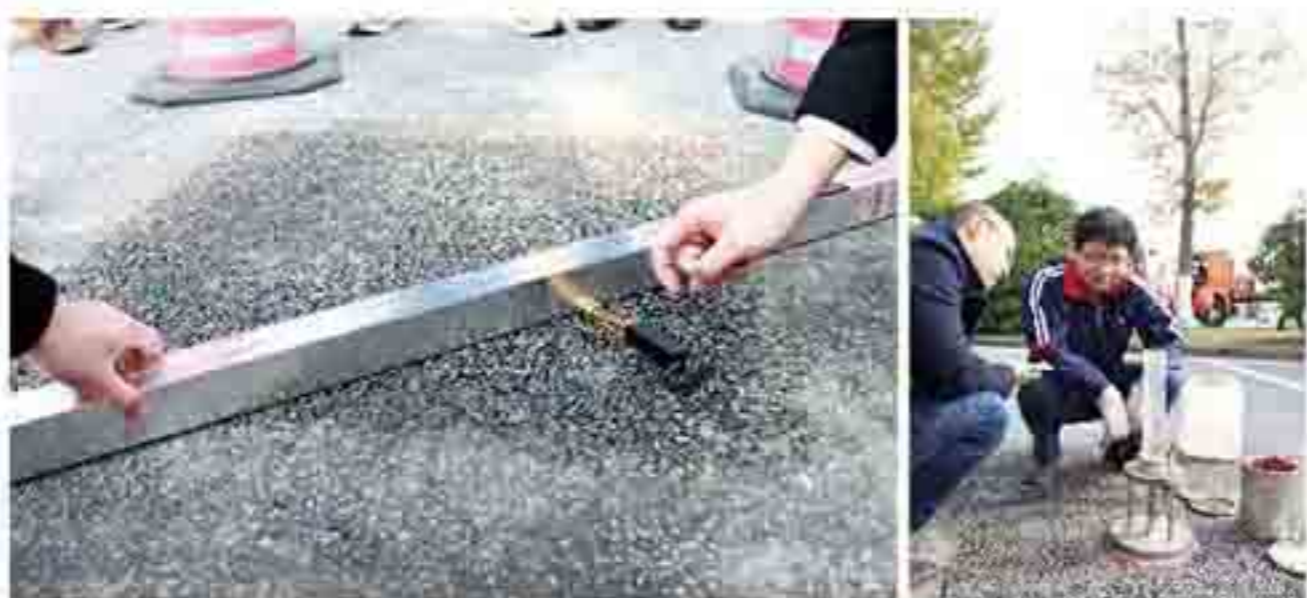
经现场检测，5个维修路段渗水系数均符合≤50ml/min标准
